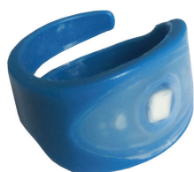
Detektor TLD umieszczony w dozymetrze
